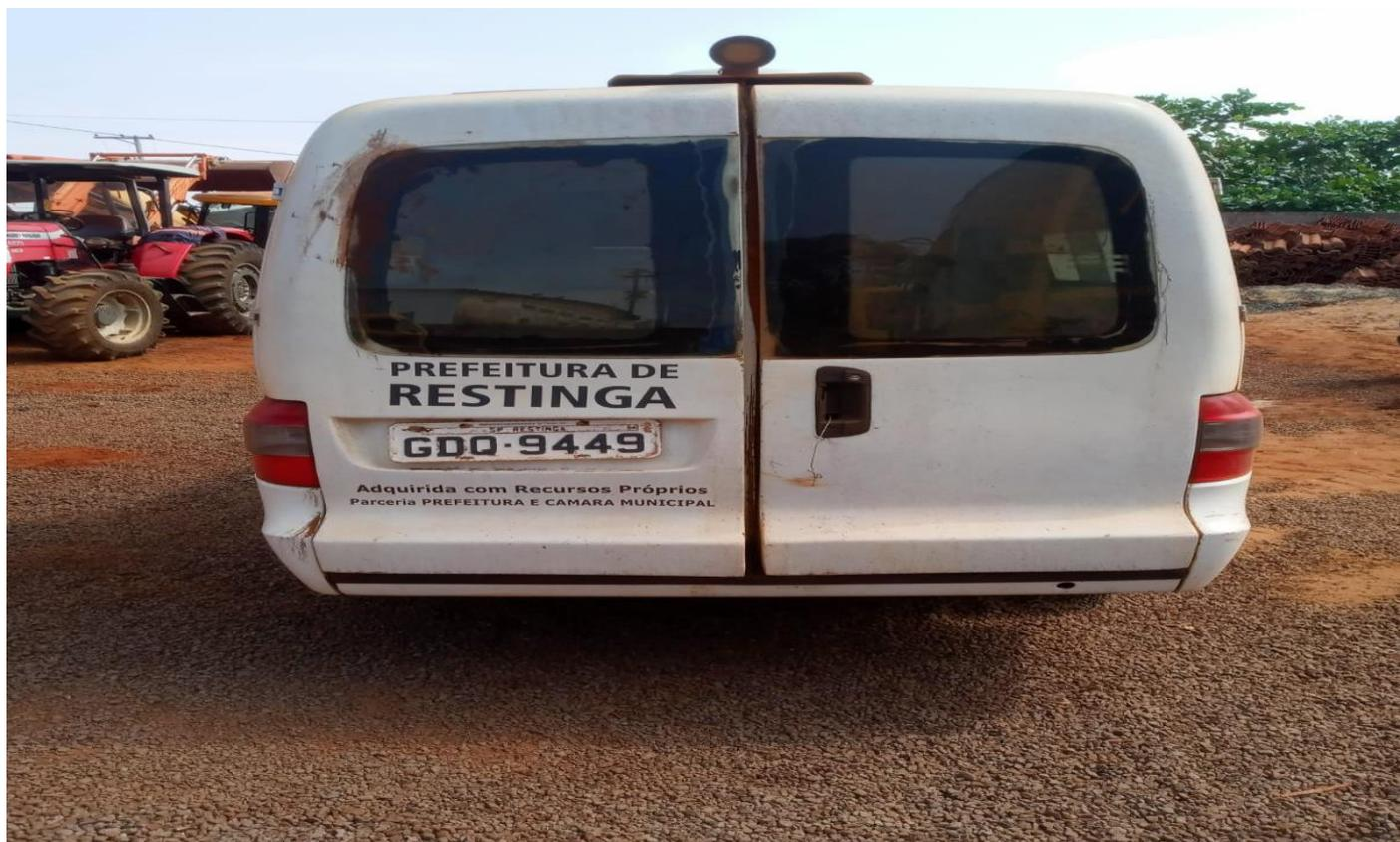
Descrição do veículo: Ambulância de simples remoção. Veículo apresenta queimadura no brilho da pintura em geral pela exposição as intempéries do uso normal com brilho da pintura ofuscado esbranquiçado pela uso de sabão ativado, não apresenta amassados os bancos do veículo apresenta condições de uso estando em perfeito estado.
